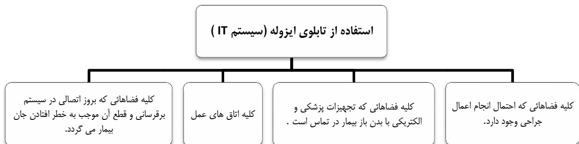
شکل ۵-۲- استفاده از تابلوی ایزوله (سیستم IT)
